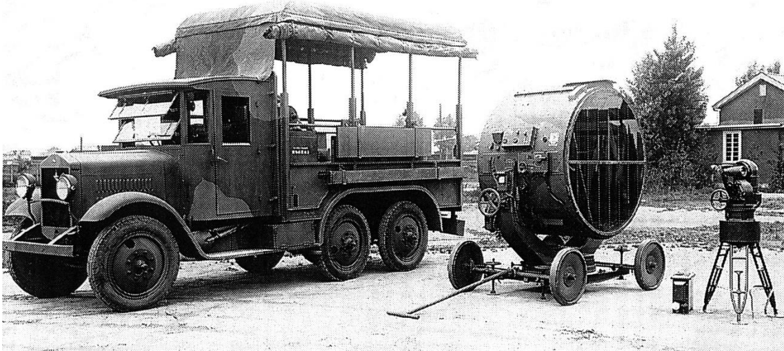
図 14 スミダ PC ないし PCA 型探照灯自動車と 93 式探照灯
